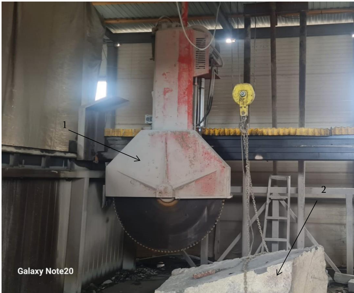
ნახ. 5 ქვის ბლოკიდან და(ან) ნამზადიდან ლუგვის („ბალვანკა“) მიღება. 1 - ხიდურა ხერხი 2-ქვის ბლოკი;
